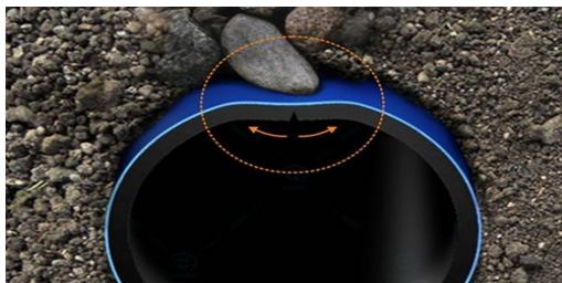
Рис. 2. Міцність поліетиленові труби з посиленням покриттям
