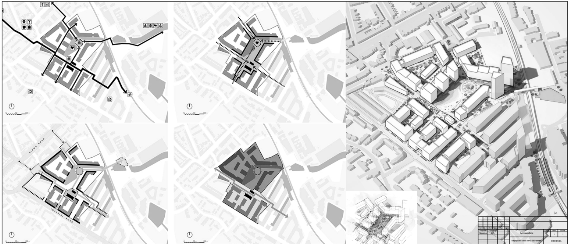
Рис. 25 Приклад допоміжних схем генерального плану мікрорайону
